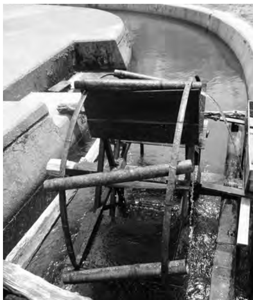
河原の和奈で見掛けした水汲み水車は秀逸。水路の水を巧みに汲み上げるが、そのためのエネルギーは水流のみ。
